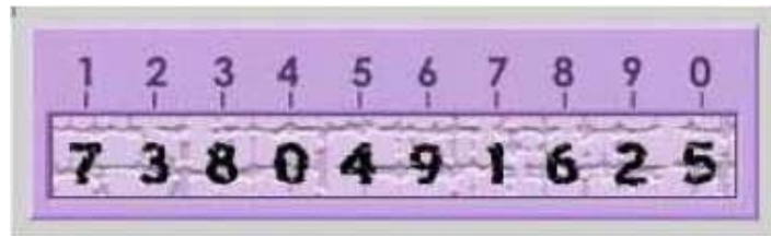
Abb. 1: Ein Anwender mit der PIN „1234“ müsste aus diesem Security-String das Einmalpasswort „7380“ ableiten.
